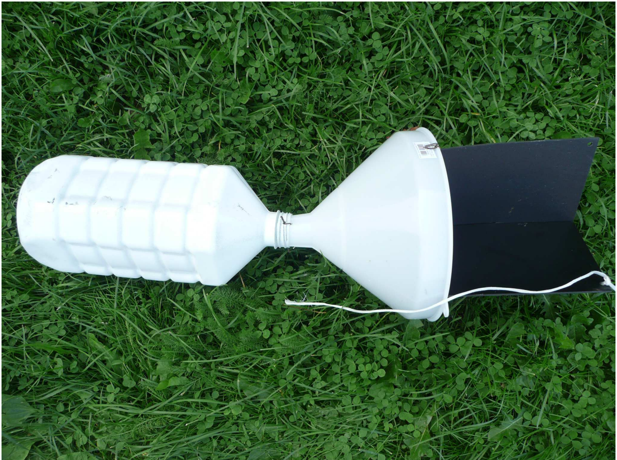
Fot.1. Pułapka z ekranem o wymiarach 25x20 cm z czarnej płyty PCV przymocowanej do lejka 25 cm średnicy zakupionego w firmie Biowin. Wykonał: Bartłomiej Bujnik
