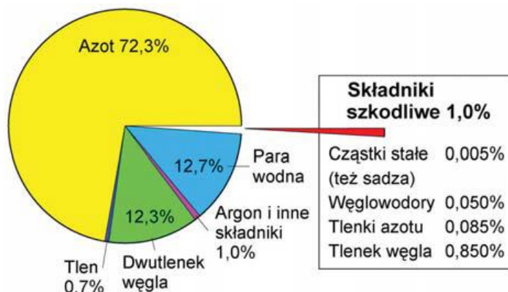
Ryc. 1 Skład spalin z silników samochodowych (Na podstawie: Analiza składu spalin silników samochodowych. Kompendium wiedzy praktycznej. Inter-Cars, 2008)
