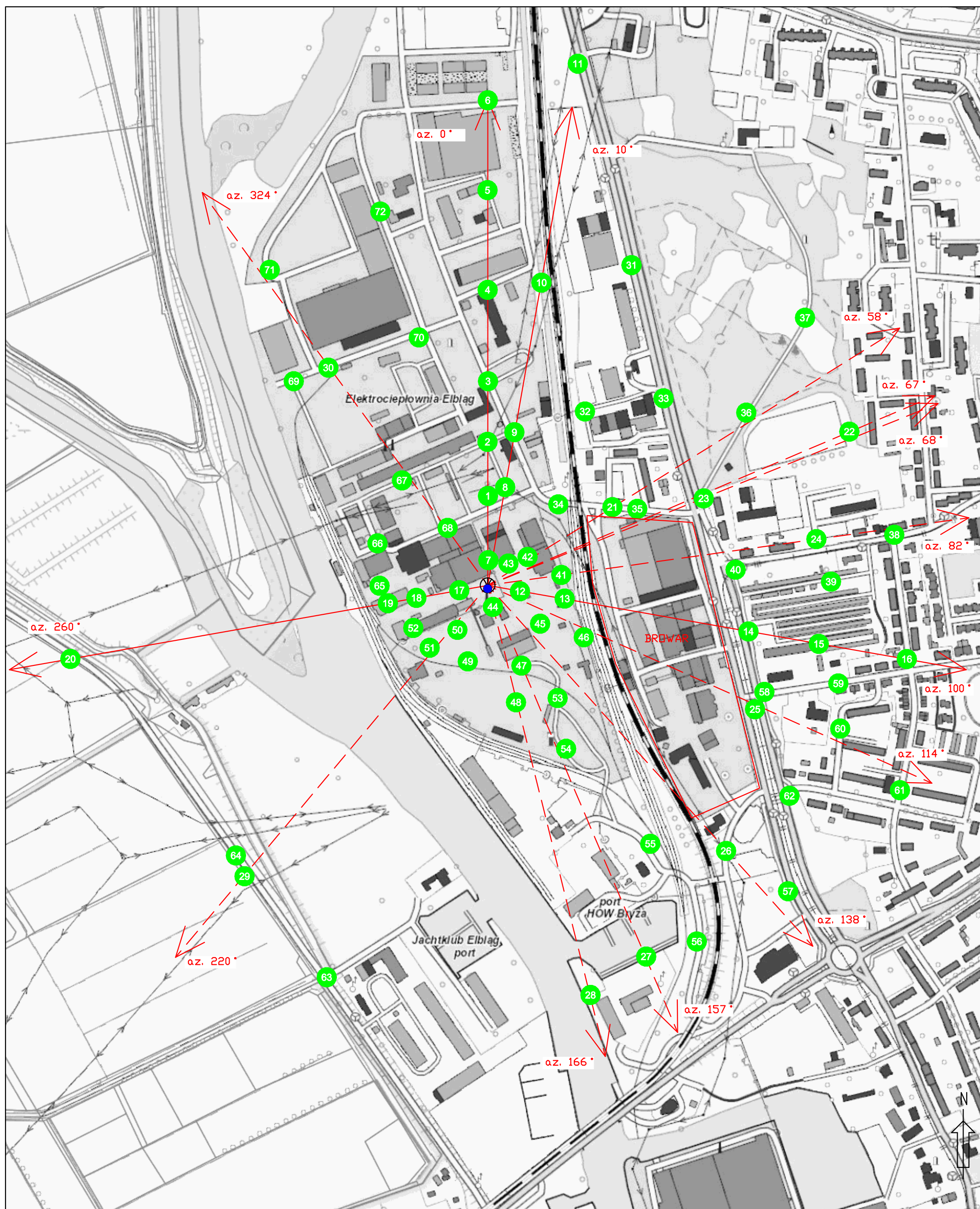
Rys.1 Lokalizacja pionów pomiarowych
